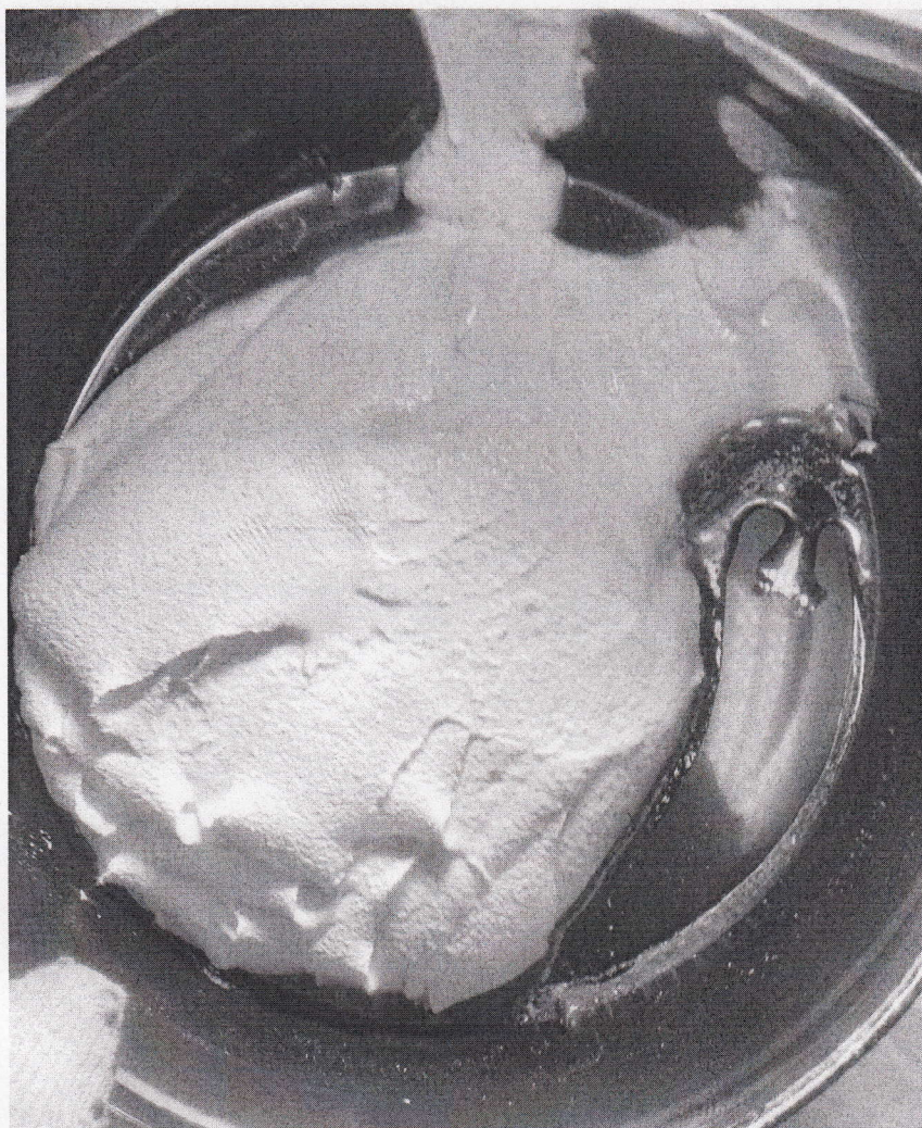
Фото 4. Компонент А после испытаний на морозостойкость
